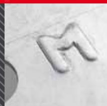
AL-KO-Chassis mit der „M“-Prägung am Längsrahmen (ab Baujahr 2010) verfügen serienmäßig über Aufnahmebohrungen für das MAMMUT-System. Die für die Stabilität notwendige Querstrebe beansprucht keinen Raum unterhalb des Chassis. So bleibt die Bodenfreiheit maximal.
